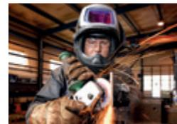
Des accessoires ignifuges pour la protection contre le métal en fusion, les étincelles et les flammes existent pour la tête et le cou.
