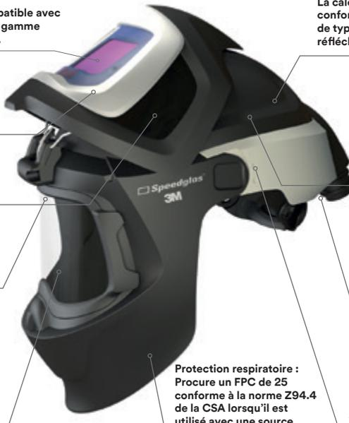
La calotte supérieure est faite de polycarbonate résistant à la chaleur et est conforme à la norme Z89.1-2009 de l'ANSI relative aux casques durs industriels de type 1, classe G. De plus, le tissu en aluminium à haute visibilité offert en option réfléchit les chauds rayons du soleil et la chaleur produite pendant le soudage.
