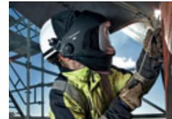
À l'aide de l'adaptateur pour casques de protection, vous pouvez facilement utiliser bon nombre des casques de protection de l'industrie avec le masque pour soudeurs 9100 FX Speedglas<sup>MC</sup> 3M<sup>MC</sup>.
